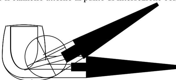
Come si può vedere il foro ha ruotato in modo diverso dal cannello e si è dovuto aggiungere del materiale sul fondo, modificando sensibilmente l'impostazione generale della pipa. Quella ottenuta, di fatto, è una pipa diversa da quella originale.
