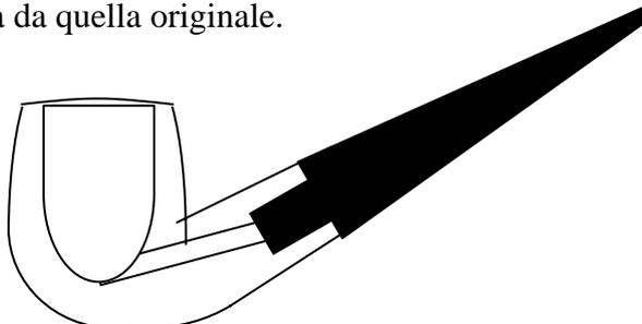
La non continuità della linea dei fori creerà una turbolenza con la conseguente formazione di condensa (a parte l'eventuale presenza di una camera di espansione) e il maggior spessore del fondo tenderà a far ristagnare l'umidità. Di fatto è aumentata la "resistenza" della pipa.
